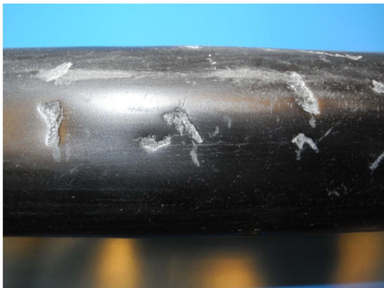
Рис. 26 Наиболее сильное воздействие на оболочку кабеля в щебне крупной фракции
